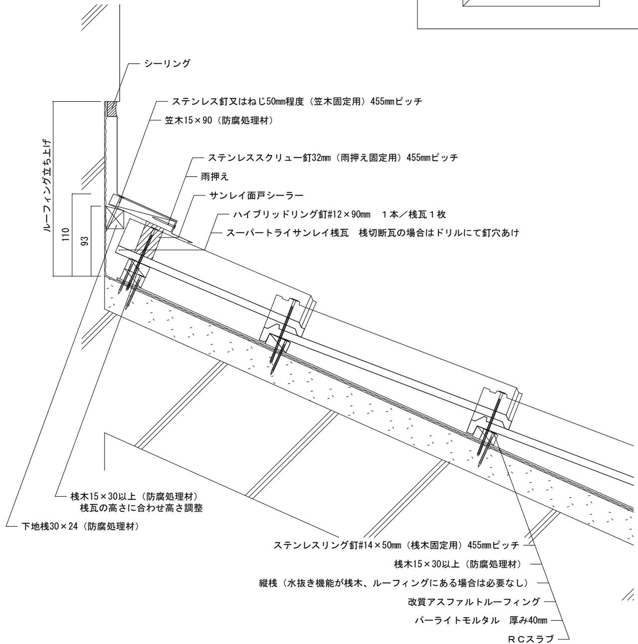
備考：この図はルーフィングより上の屋根材の納まり例です。屋根構造及び屋根下地材の施工方法を示すものではありません。
