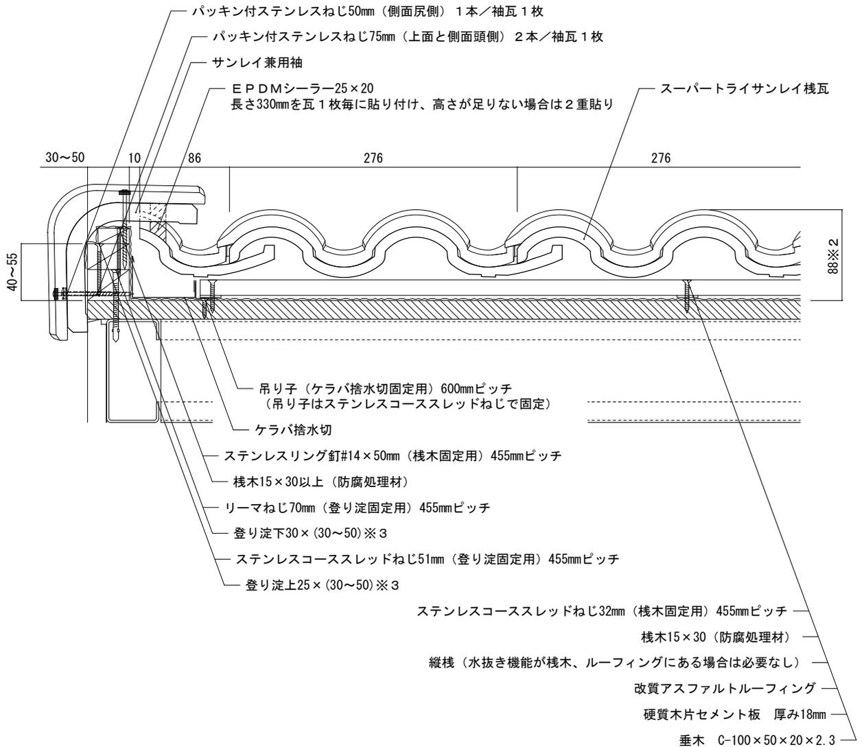
備考：この図はルーフィングより上の屋根材の納まり例です。屋根構造及び屋根下地材の施工方法を示すものではありません。4.0寸勾配以上共通。
