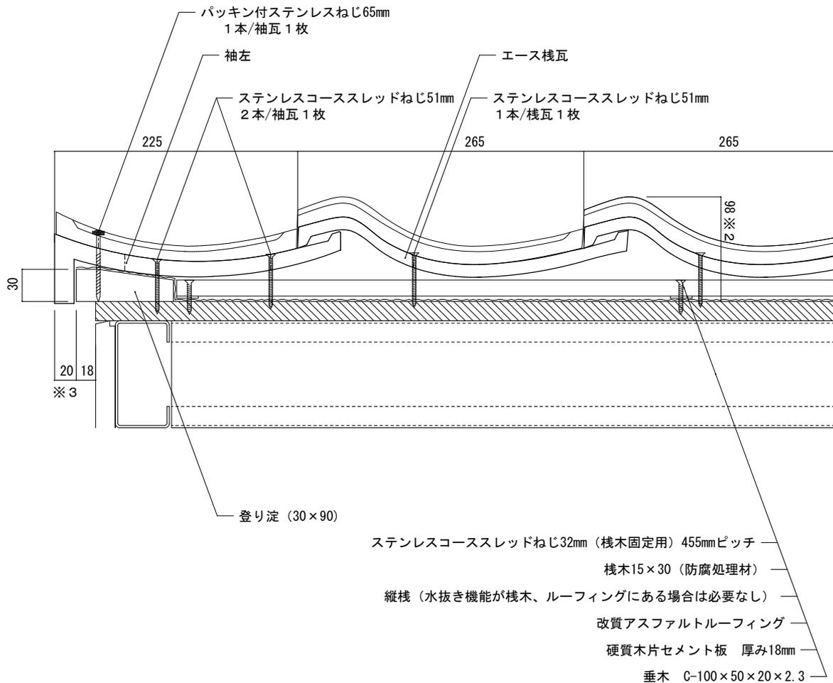
備考：この図はルーフィングより上の屋根材の納まり例です。屋根構造及び屋根下地材の施工方法を示すものではありません。4.0寸勾配以上共通。
