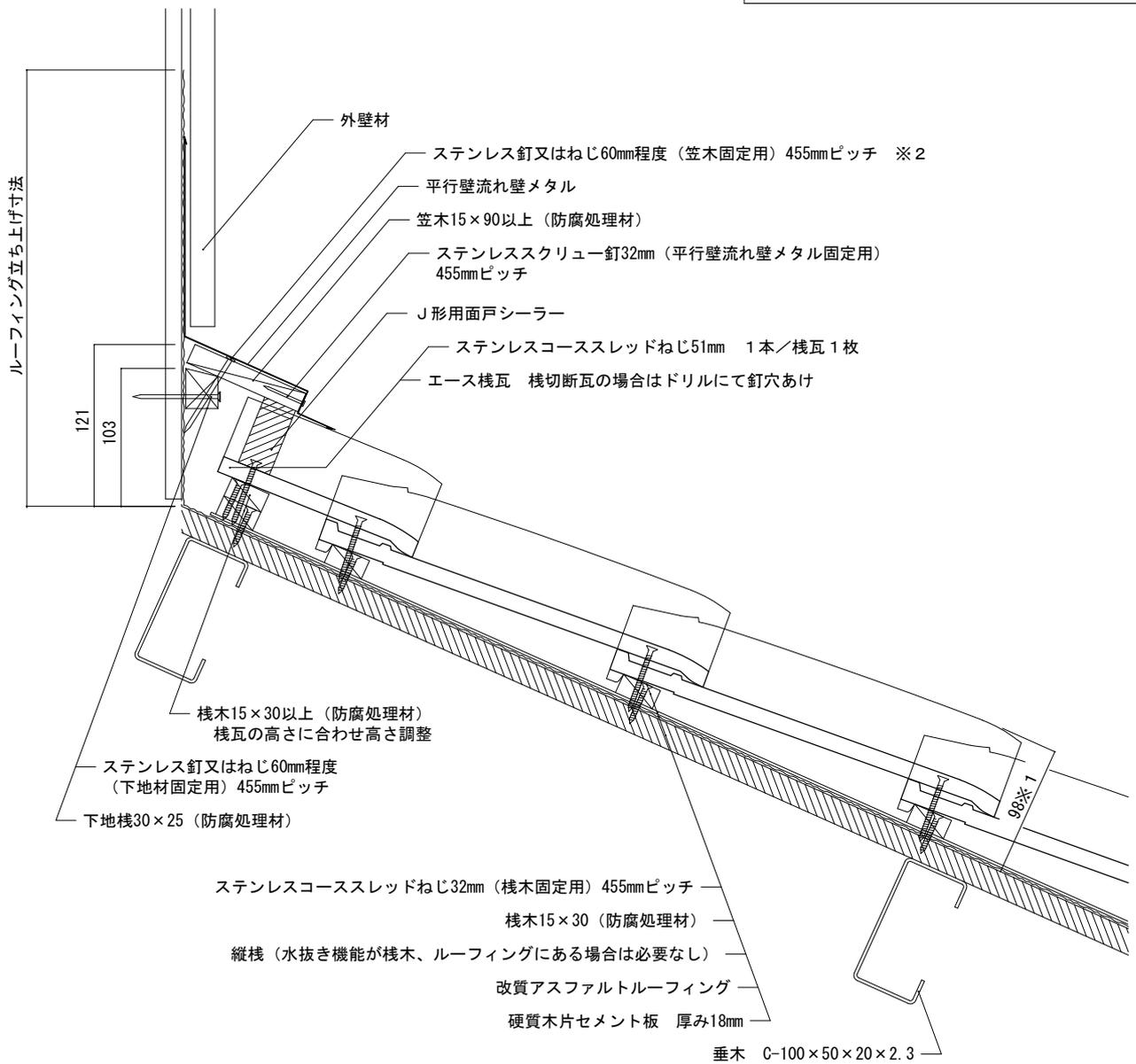
備考：この図はルーフィングより上の屋根材の納まり例です。屋根構造及び屋根下地材の施工方法を示すものではありません。
