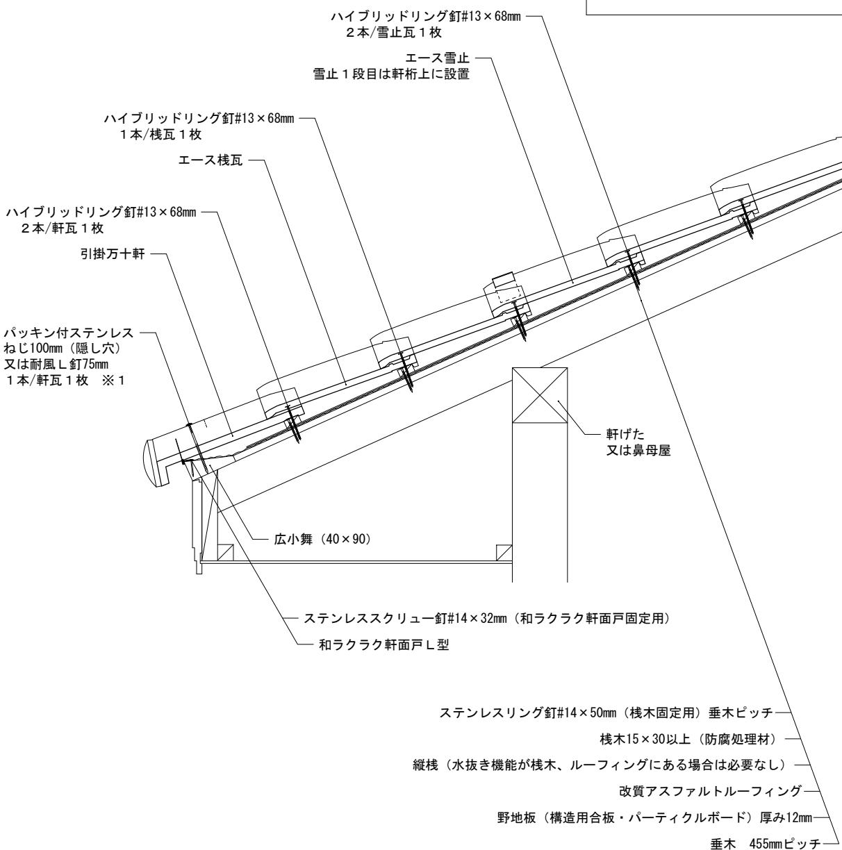
備考:※1 図はパッキン付ステンレスねじ100mm (隠し穴) を示しています。(軒瓦の軒先固定)
