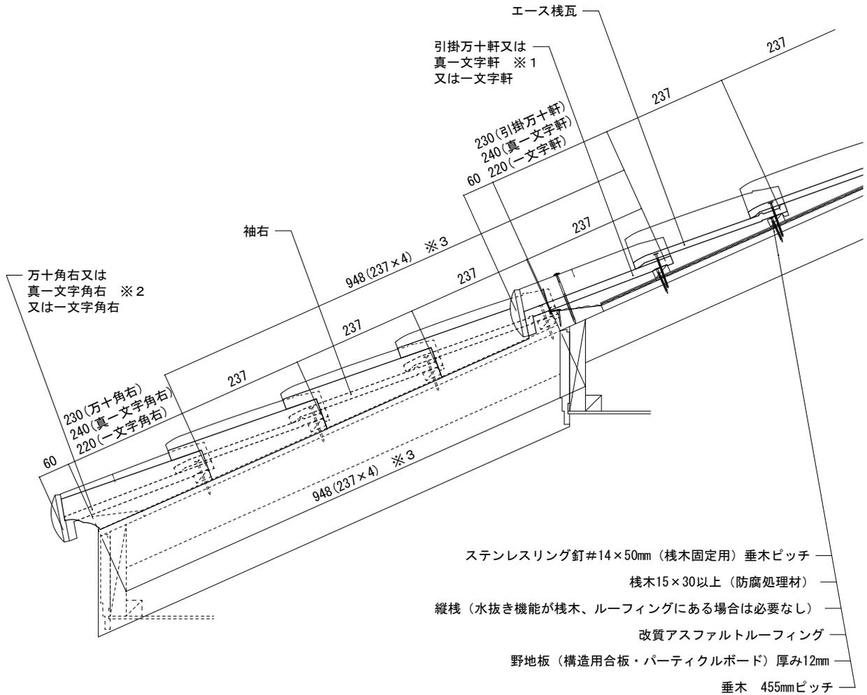
備考: ※1図は引掛万十軒を示しています。 ※2図は万十角右を示しています。 ※3すがりの瓦割りは237 (棧瓦の働き長さ) の倍数になります。
