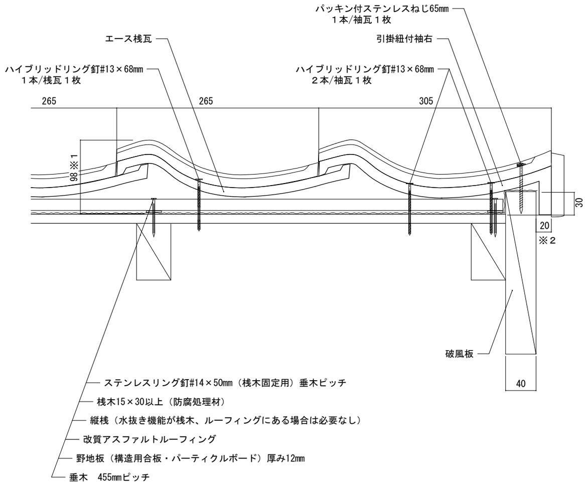
備考：※1 野地板から瓦表面までの最高高さを示しています。（野地板から棧木下端までの高さは5mmとしています。）
