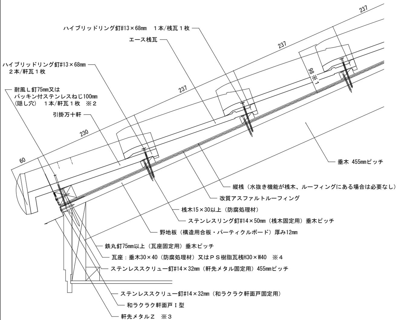
備考：※1 野地板から瓦表面までの最高高さを示しています。（野地板から桧木下端までの高さは5mmとしています。）
