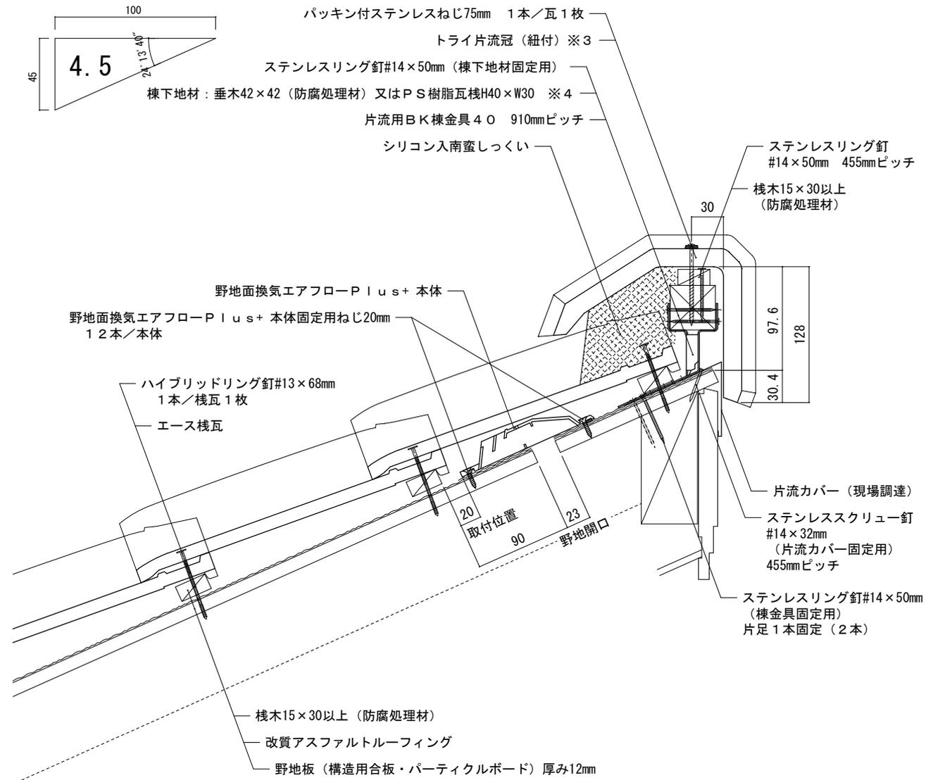
※1 野地面換気エアフローPlusは片流、方形屋根、急勾配屋根、平行壁際に使用できます。図は片流の納まりを示しています。※2 取付位置は出来るだけ最上段の檼瓦下に取り付けます。最上段が檼切断瓦の場合又は方形屋根の場合には、2段目又は3段目の檼瓦下に取り付けます。※3 トライ片流冠（紐付）は平板瓦の役瓦です。エースの対応色と異なりますので注意してください。※4 図は垂木42 x 42 (防腐処理材)を示しています。
