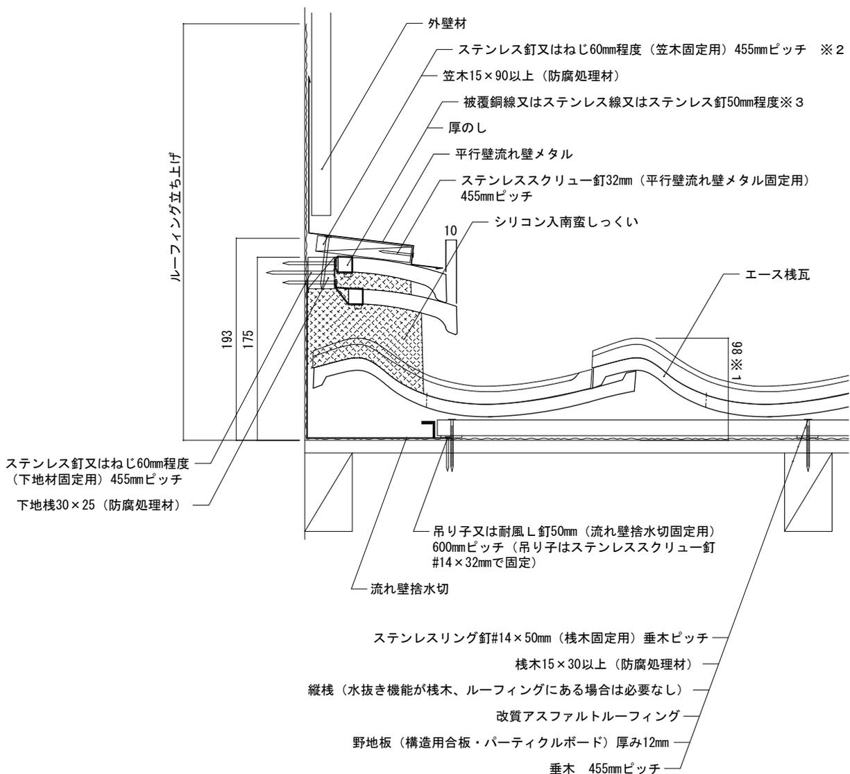
備考：※ 1 野地板から瓦表面までの最高高さを示しています。（野地板から棧木下端までの高さは5mmとしています。）
