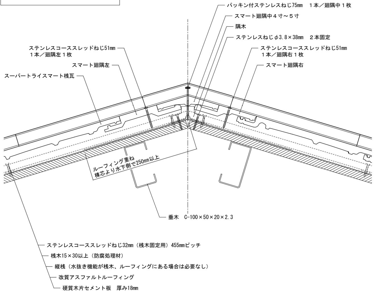
備考：この図はルーフィングより上の屋根材の納まり例です。屋根構造及び屋根下地材の施工方法を示すものではありません。
