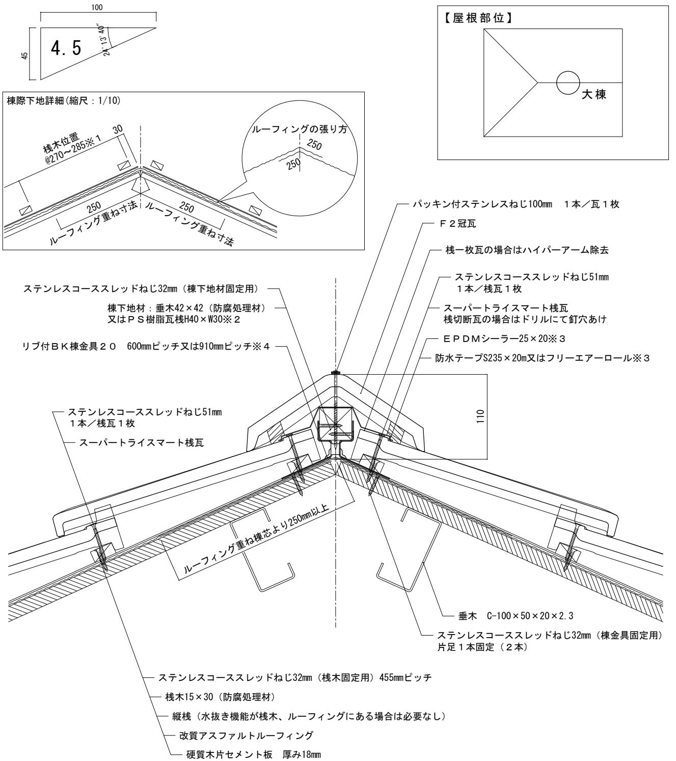
備考: この図はルーフィングより上の屋根材の納まり例です。屋根構造及び屋根下地材の施工方法を示すものではありません。
