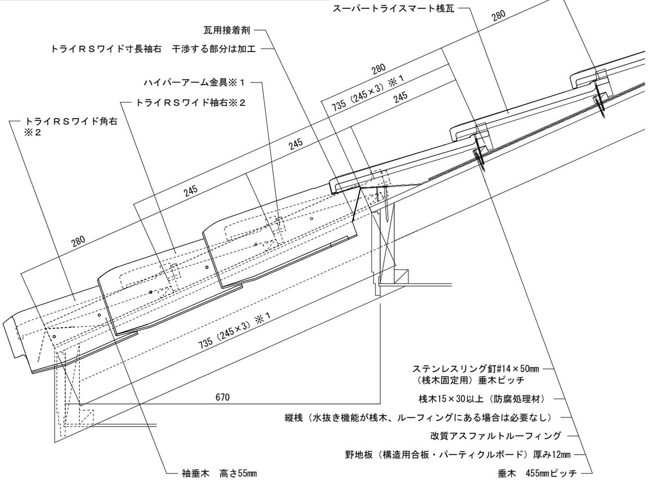
備考：※1 すがりの野地寸法は均等割り付けをします。図は棧瓦の割り付け寸法が240~259の場合です。この場合、すがりの棧瓦のハイパーアームを除去するためハイパーアーム金具にて補強します。なお、この図は245の場合を示しています。
