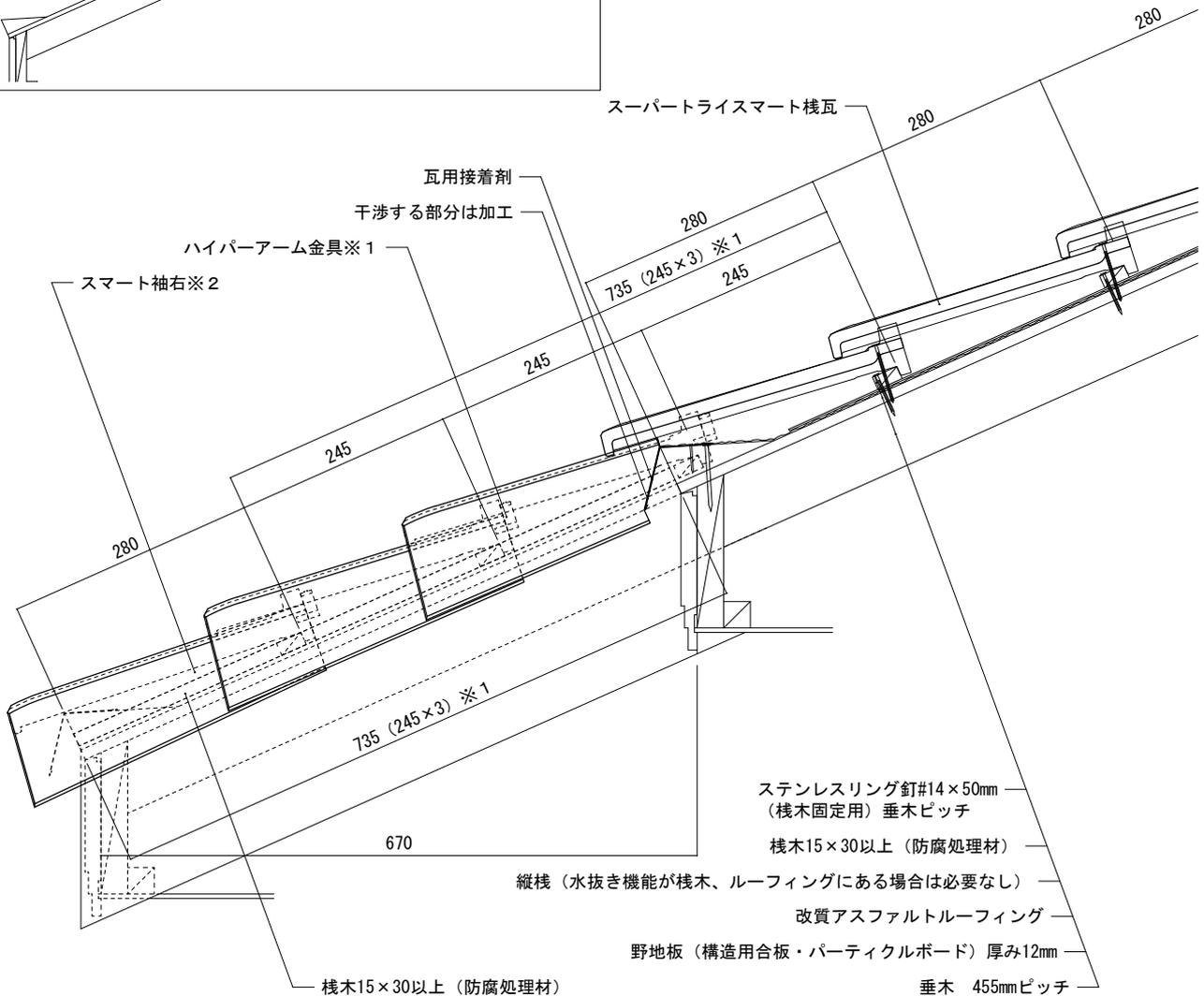
備考：※1 すがりの野地寸法は均等割り付けをします。図は棧瓦の割り付け寸法が240~259の場合です。この場合、すがりの棧瓦のハイパーアームを除去するためハイパーアーム金具にて補強します。なお、この図は245の場合を示しています。
