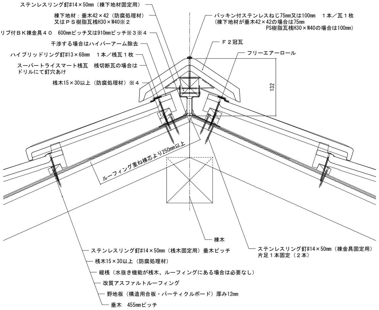
備考：棟換気は図面番号F形SM-構12-換-1（P-換）になります。※1軒先2段目以降の働き長さは、寄棟屋根（廻隅瓦）では4.0寸勾配275mm、4.5寸勾配280mm、5.0寸勾配285mmとなります。切妻屋根では270～285mmの範囲で調節することが出来ます。※2図は垂木42×42（防腐処理材）を示しています。 ※3フリーエアーロールを使用する場合は、600mmピッチを推奨します。※4棟金具40では、棧一枚瓦・棧切断瓦どちらの場合でも檼木は2段積みします。
