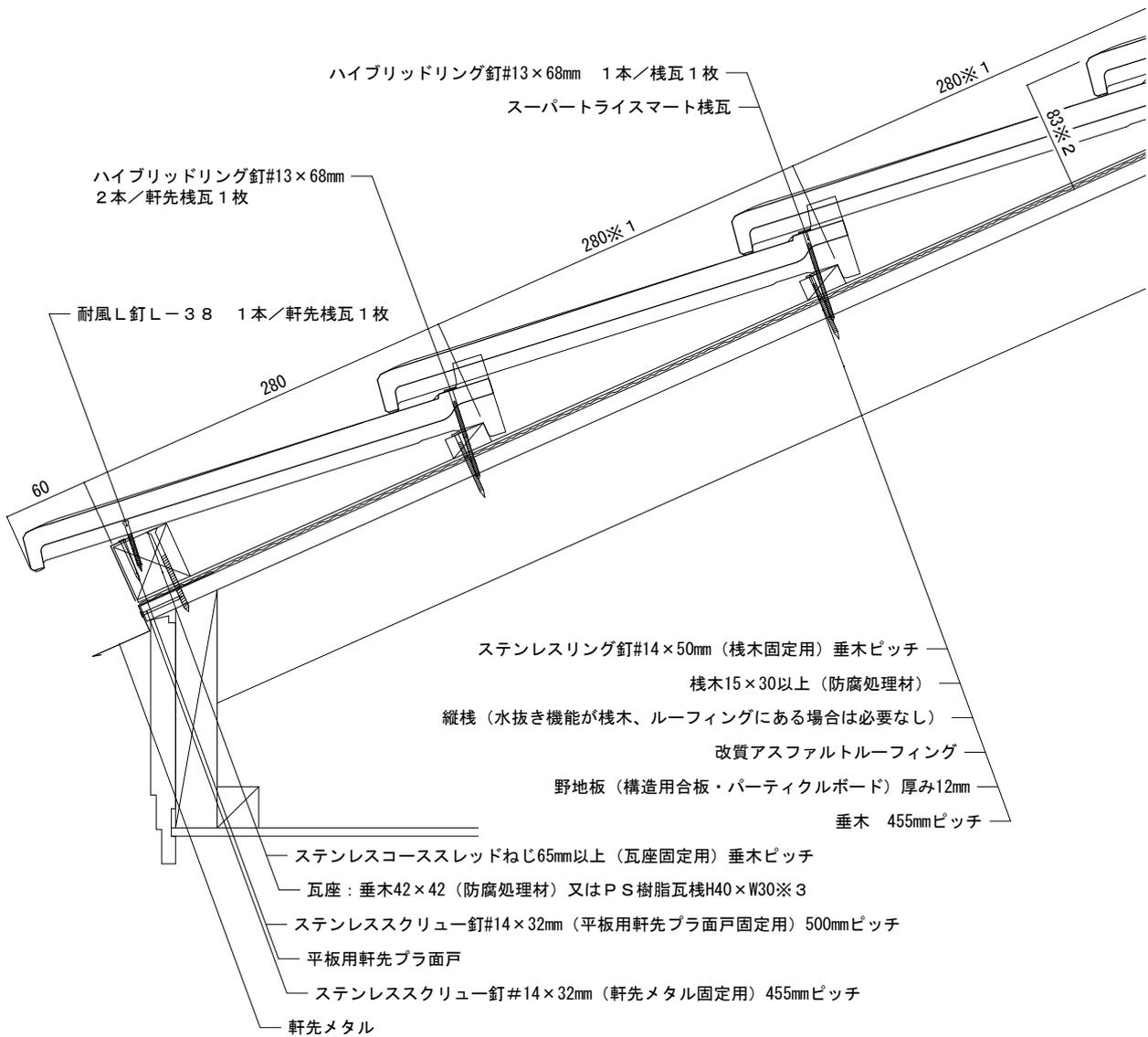
備考：※1 軒先2段目以降の働き長さは、寄棟屋根（廻隅瓦）では4.0寸勾配275mm、4.5寸勾配280mm、5.0寸勾配285mmとなります。切妻屋根では260～285mmの範囲で調節することが出来ます。※2 野地板から瓦表面までの最高高さを示しています。（野地板から棧木下端までの高さは5mmとしています。）※3 図は垂木42×42（防腐処理材）を示しています。
