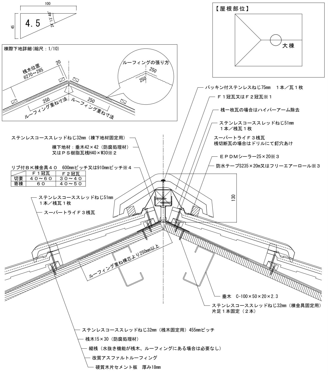
備考: この図はルーフィングより上の屋根材の納まり例です。屋根構造及び屋根下地材の施工方法を示すものではありません。
