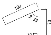
備考:※1図は垂木42×42（防腐処理材）を示しています。※2図は防水テープS235×20mを示しています。フリーエアーロールを使用する場合はE P D Mシーラー-25×20は必要ありません。※3防水テープ又はフリーエアーロールを使用する場合は、600mmピッチを推奨します。※4タマブチ付の場合は、破風下から見上げた時にタマブチ以外の箇所に隙間が出来やすいため、気になる場合はE P D Mシーラー等を取り付けます。図は片流用BK棟金具30を示す。
