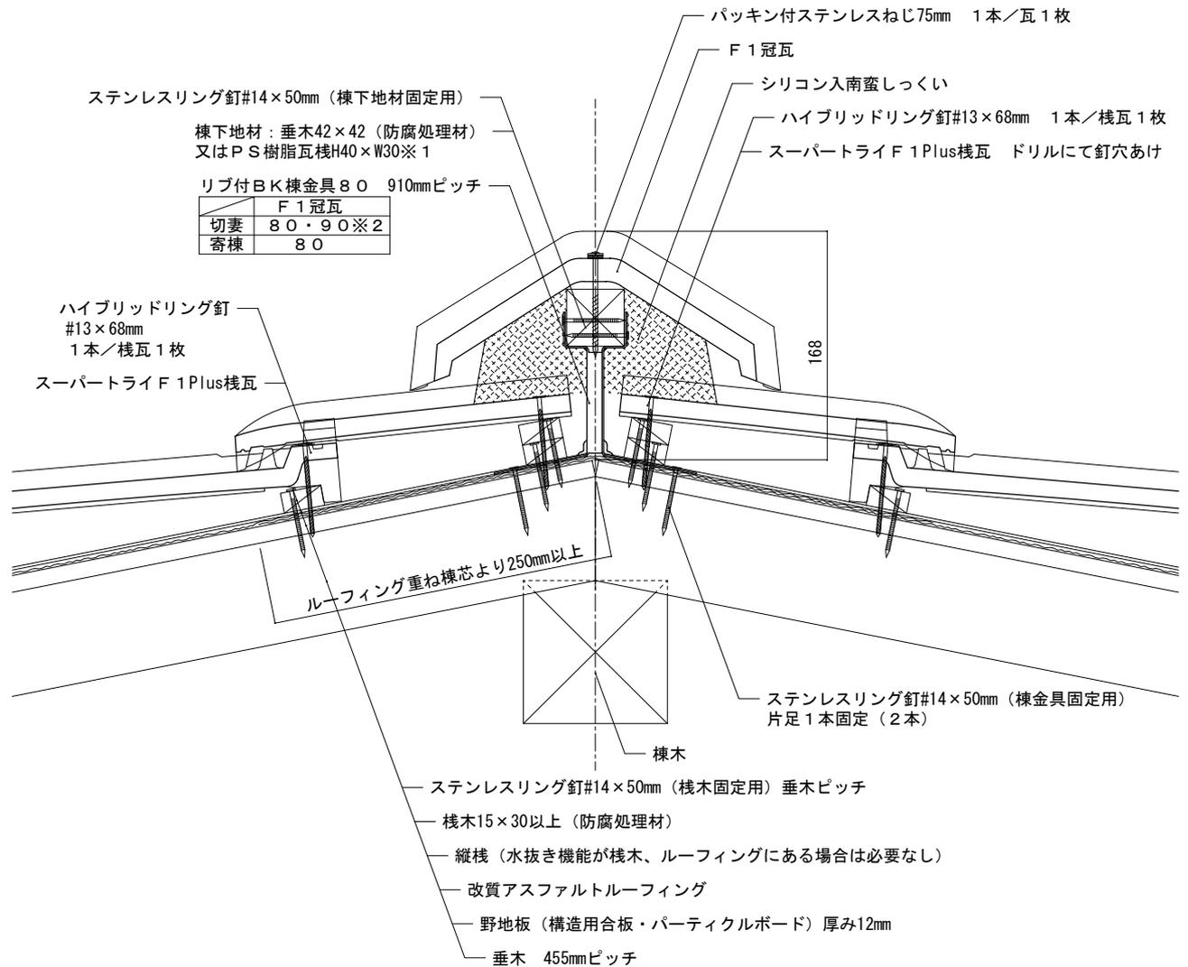
備考：※1 図は垂木42×42（防腐処理材）を示しています。※2 棧切断瓦が小さい場合は棟金具90を使用。
