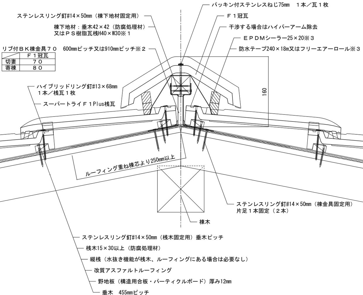
備考：※1図は垂木42×42（防腐処理材）を示しています。※2防水テープ又はフリーエアーロールを使用する場合は、600mmピッチを推奨します。
