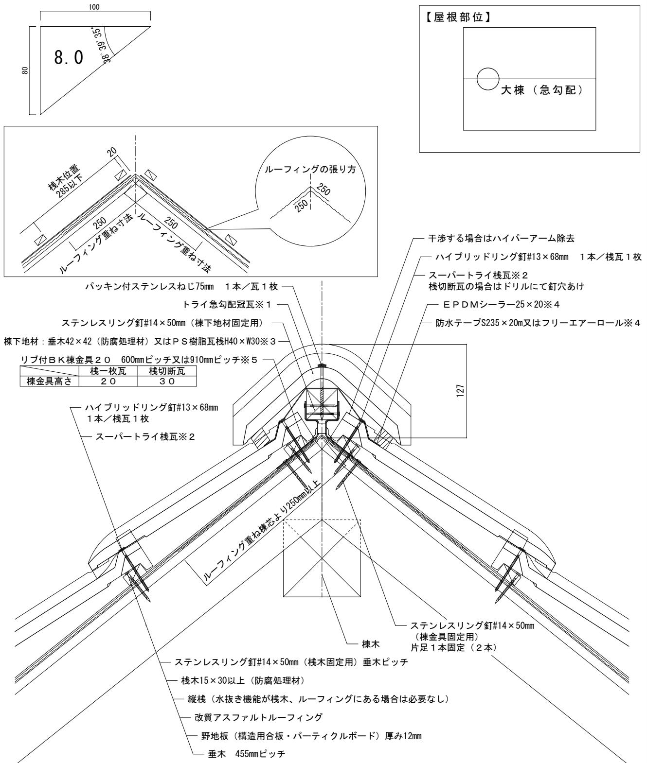
備考:8寸勾配の太棟納まりの一例です。現場状況にあわせ、上図を参考に納めてください。※1 トライ急勾配冠瓦は8~12.5寸勾配に使用できます。
