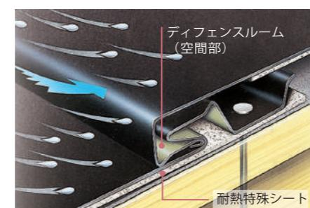
にも水滴を排出するルートを設計し、対策は万全です。防水試験では風速20メートルと30メートルの各条件で1時間に240ミリ相当の雨をクリアし※、業界トップレベルの卓越した防水性能を実証しています。
