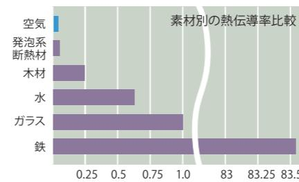
※空気はもっとも熱伝導率が低く、断熱性に大変すぐれています。発泡系断熱材も発泡の中に空気を閉じ込めることで断熱効果を發揮し、原理は空気層と同じです。
