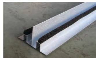
■乾式水切り 中間部材 材質：ガルバリウム鋼板0.27厚 長さ：3,030mm 色：素地色のみ
