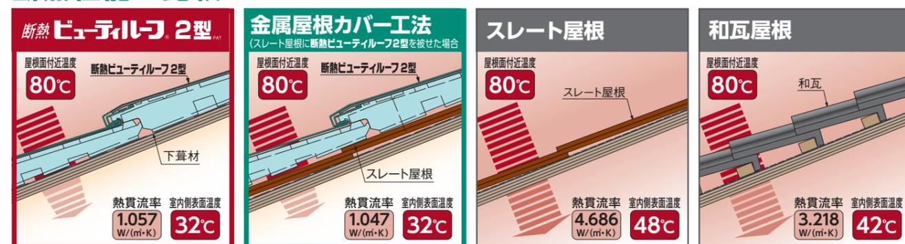
※室内側表面温度は、屋根面付近温度80°C、室内温度27°Cに設定し、熱貫流率から野地材の表面温度を算出しています。
