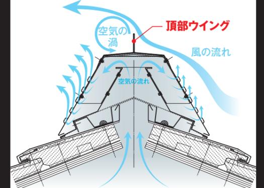
頂部ウイングを取り付けることにより漏が発生し、圧力が低くなり、そこに内部の空気が引き寄せられる
