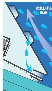
豪雨時、強風で吹き上げられる雨水を弾き、浸入を防ぎます。上向きルーバーから入った雨水は溝から外部に排出される構造です。
