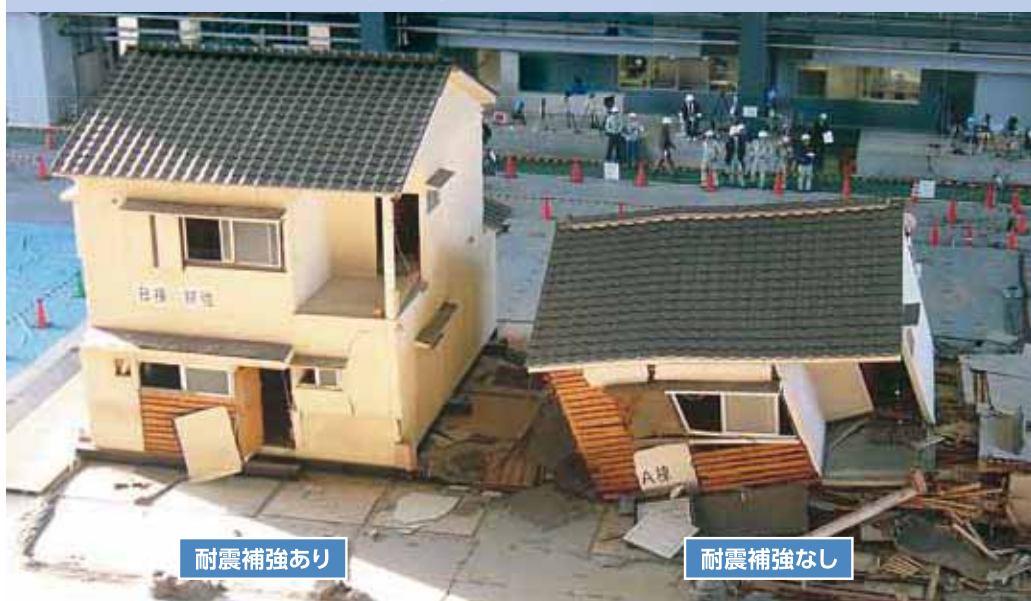
震度7クラスの揺れにも耐える振動実験
