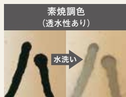
汚れが染み込み、跡が残る
