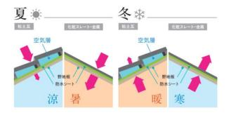
粘土瓦は、焼き物特有の高い断熱性をもちます。また、屋根面と瓦の間にある「空気層」には夏の熱気・冬の冷気を屋内に伝えにくく、冷暖房の効果を外に逃しにくいはたらきがあります。
