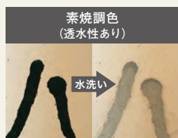
汚れが染み込み、跡が残る
