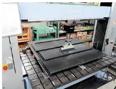
陶板屋根材「スーパートライ美軽(みがる)」 曲げ破壊試験の様子
