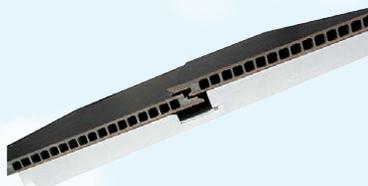
陶板を中空構造にすることで、軽量化(28kg/m<sup>2</sup>)を実現。さらにEPSマット下地材と共に空気層を作り、高い断熱性を誇ります。
