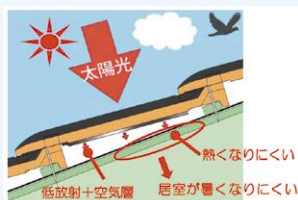
▲低放射+瓦下空気層が、 熱気や冷気を遮断
