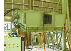
圧力箱方式防水性能試験
