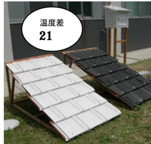
名古屋工業大学での研究「瓦の太陽熱吸収特性に関する研究」で、最高気温(百葉箱内気温40℃)での瓦表面温度測定結果が、黒色瓦(マットブラック)表面温度74℃に対し、白色瓦(スノーホワイト)表面温度は53℃となり、21℃もの温度差を示す結果を得ました。
