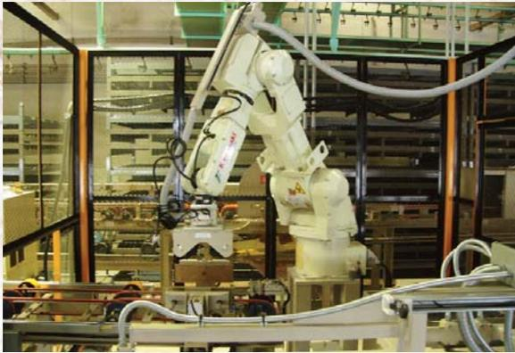
屋根材市場のニーズ多様化に柔軟に対応するために、和形役瓦（のし瓦）専焼の本社工場第2ラインの生産設備の改修を開始し、平成17年11月に、和洋兼用役瓦生産設備として完工いたしました。最新のアーム型ロボット5基を搭載する工場は業界初で、洋形役瓦の生産効率を高め、更なる品揃えの充実化に努めてまいります。
