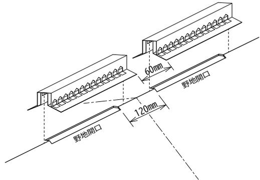
(2) 棟金具を910mmピッチで換気本体の両端に固定してください。
