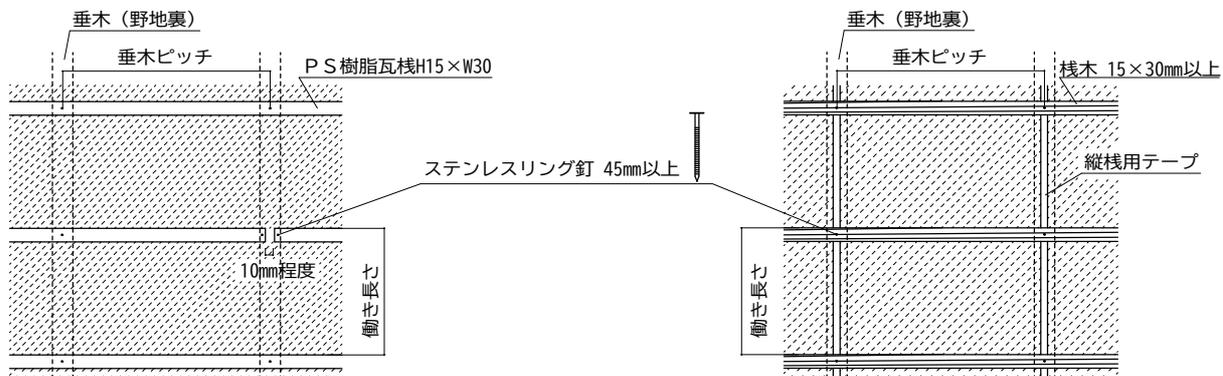
\* 差し棟工法では各屋根面の働き長さを合わせ、隅芯で棧木が交わる位置に施工してください。
