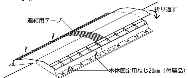
(3) 棟金具を910mmピッチで取り付けてください。
