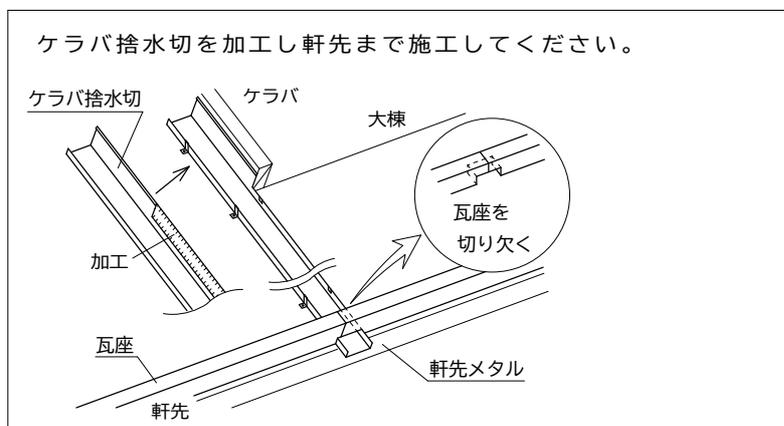
ケラバ捨水切の先端は瓦上に60mm程度出し、重ねる瓦の下に隠してください。
