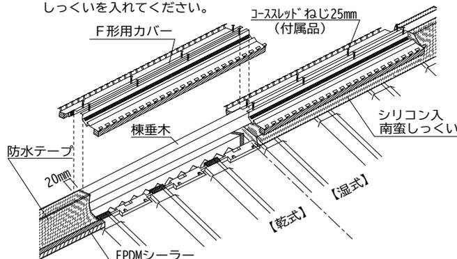
(5) F形用カバーの突起を折り倒さないように、冠瓦を付属のPッ付付スチルスねじ65mmで固定してください。F2冠瓦(タマ子付)の場合は、タマ子と干渉するF形用カバーの突起のみを折り倒して、F2冠瓦を施工してください。
