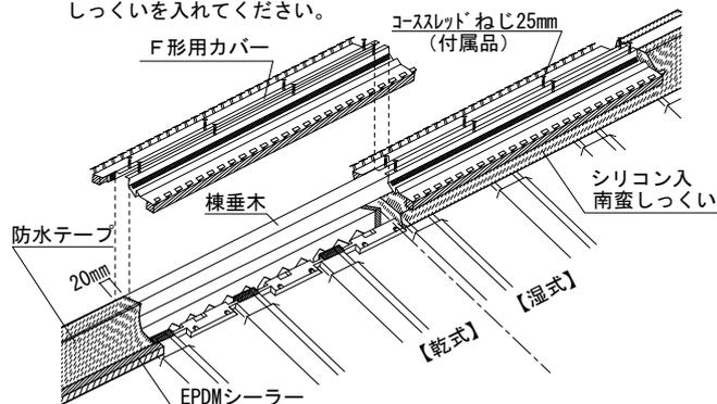
(5) F形用カバーの突起を折り倒さないように、冠瓦を付属のハック付ステンスねじ65mmで固定してください。F2冠瓦(タマチ付)の場合は、タマチと干渉するF形用カバーの突起のみを折り倒して、F2冠瓦を施工してください。
