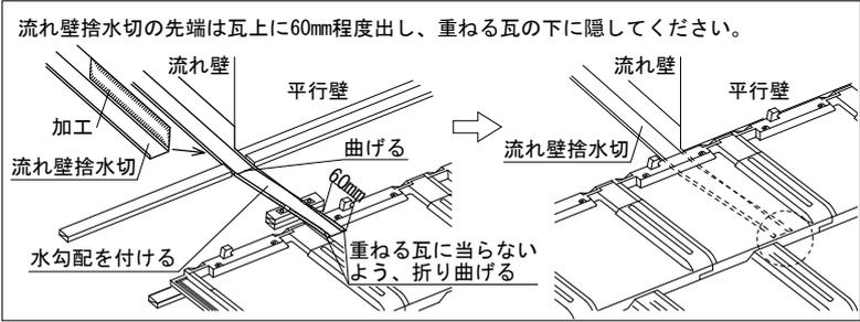
\* 平行壁、流れ壁の笠木が同じ高さになるように固定してください。笠木の高さは流れ壁の高さ（野地面から80mmの高さ）が基準となります。
