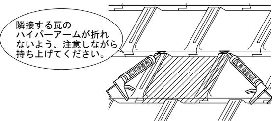
※差し替え後の瓦は釘を打ちません。瓦用接着剤で固定します。
