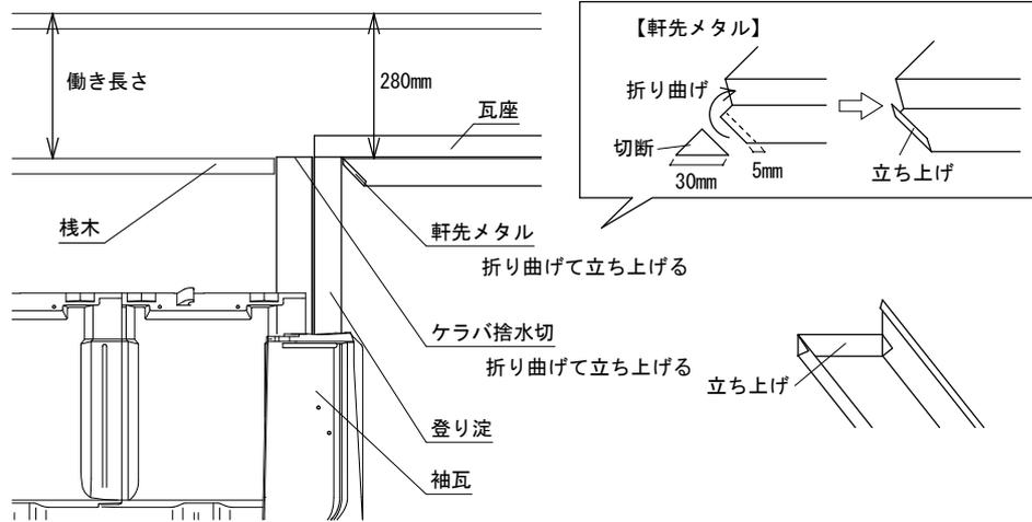
\* すがり部は図のように防水テープを貼り付けてください。すがり部の最上段は寸長袖瓦を使用し、軒先と干渉する部分を加工し、施工してください。袖瓦と棧瓦の隙間を瓦用接着剤で処理してください。
