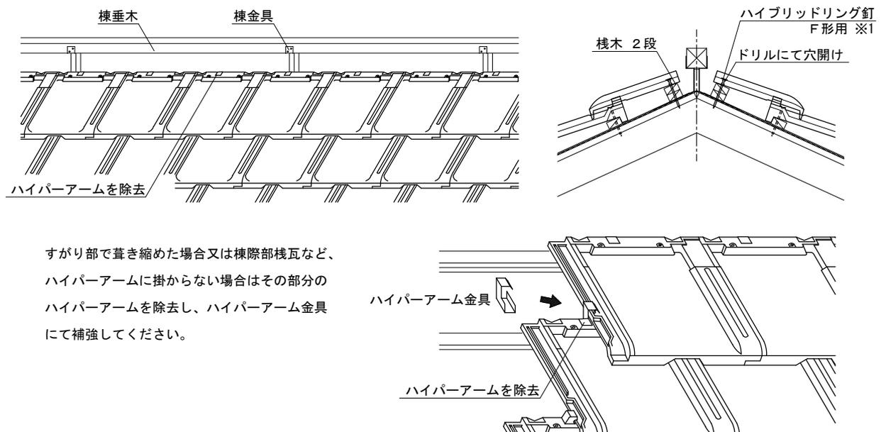
すがり部で葺き縮めた場合又は棟際部棧瓦など、ハイパーアームに掛からない場合はその部分のハイパーアームを除去し、ハイパーアーム金具にて補強してください。
