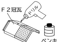
大棟の長さに合わせて切断し、ペンキを塗る
