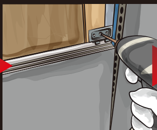
金具に引掛けて施工します。
