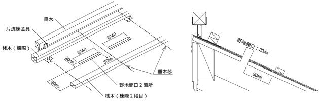
(2)エアフロー野地面取付型の下端を棟際2段目の桟木上端より20mm程度の位置に合わせ、本体固定用ねじ20mm6ヶ所で固定してください。
