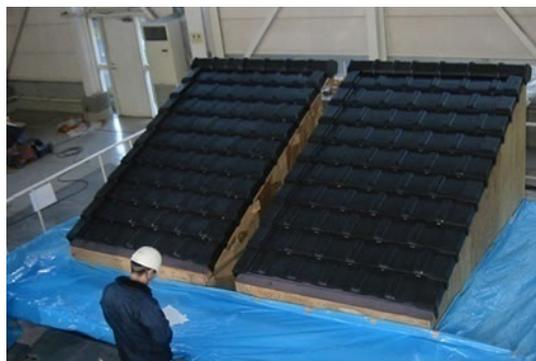
独立行政法人都市再生機構の三次元振動台にて試験を実施。阪神大震災の地震波においても瓦のずれ、破損、脱落はなく震度7クラスの地震でも脱落しない事が証明されました。
