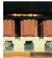
自然素材である粘土と釉薬を高温(1130°C)で焼き締めた、表面がガラス質の被膜で覆われた陶器質の屋根材です。変色や変質を起こしにくく、時間が経過しても美しい外観を保つことができます。セメント系屋根材のように、表面が塗料による着色でないため、塗り替えの必要はありません。
