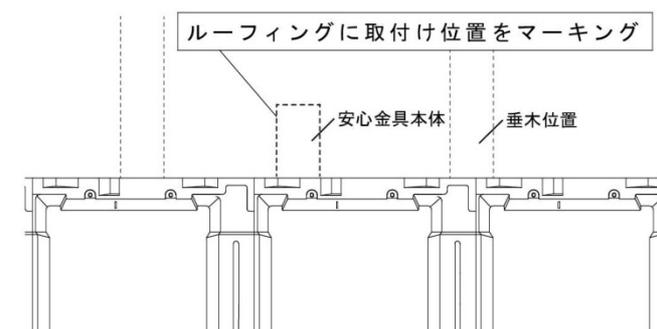
③取付け位置の下の段まで瓦を施工してください。安心金具本体をなるべく垂木間の中央になるように仮置きし、取付け位置の確認してください。
